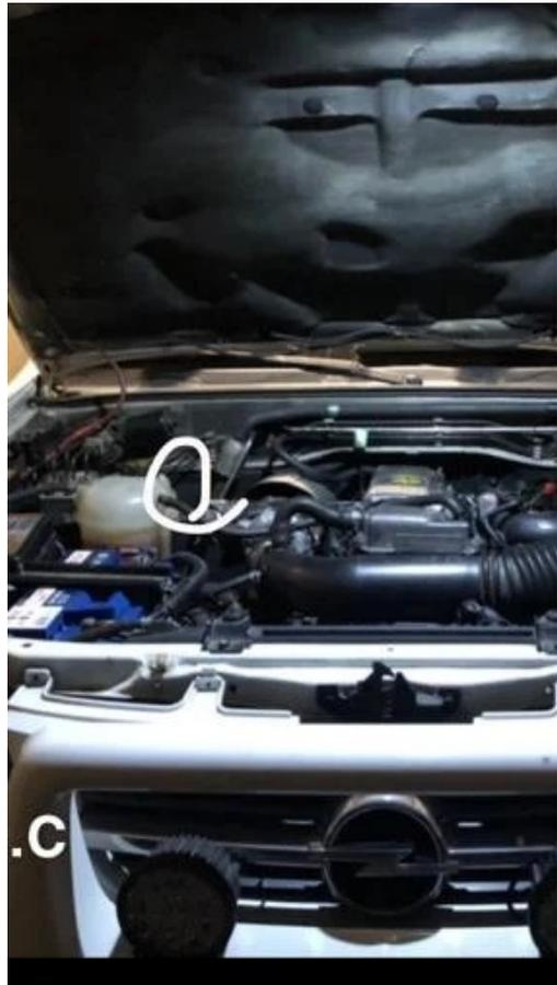
**3 Démontez la Tôle de protection thermique du turbo/collecteurs. (ne pas oublier la petite du fond) (BTR de 5 pour ma part)**
