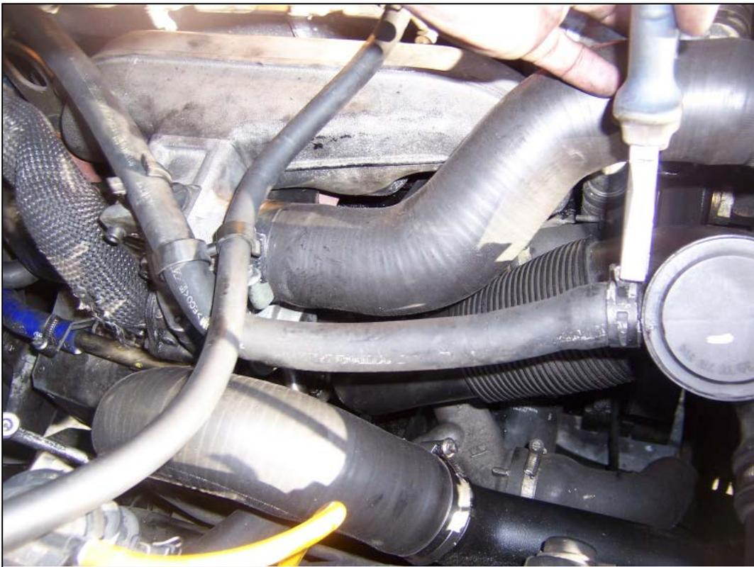
On enlève la durite supérieure (qui vient de l'intercooler et va à la vanne EGR). Desserrer les deux colliers avec un tournevis.
