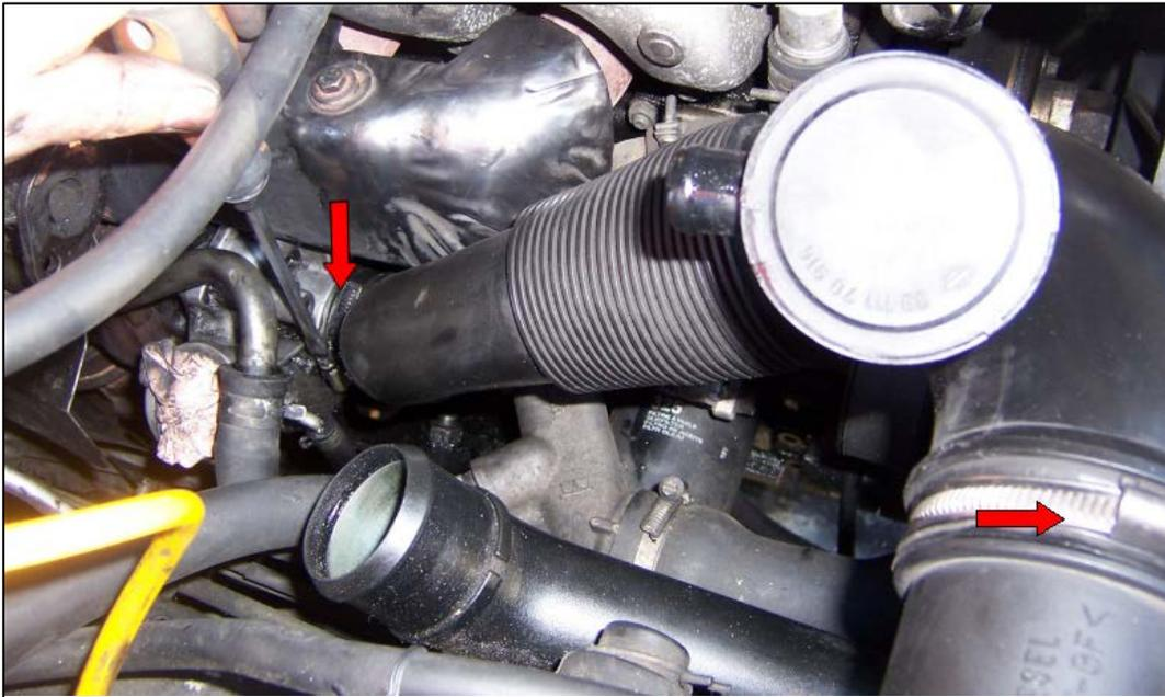
Le TIS demande de démonter le tube de chauffage. Pour éviter de vidanger le liquide de refroidissement, nous allons le laisser en place et faire avec... Idem pour le tuyau de retour du vase d'expansion.
