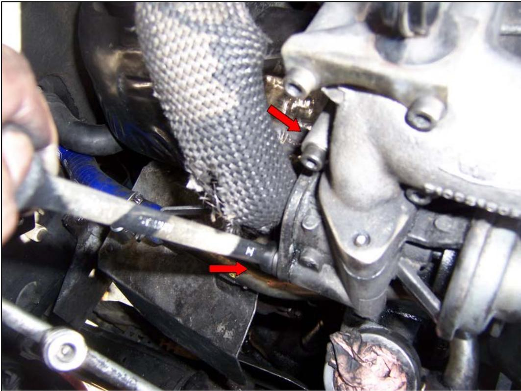
Ensuite on défait les quatre vis BTR qui fixe la vanne. Attention, il y a un joint métal derrière. Ne pas l'abimer. Clé à cliquet avec embout BTR appréciable.
