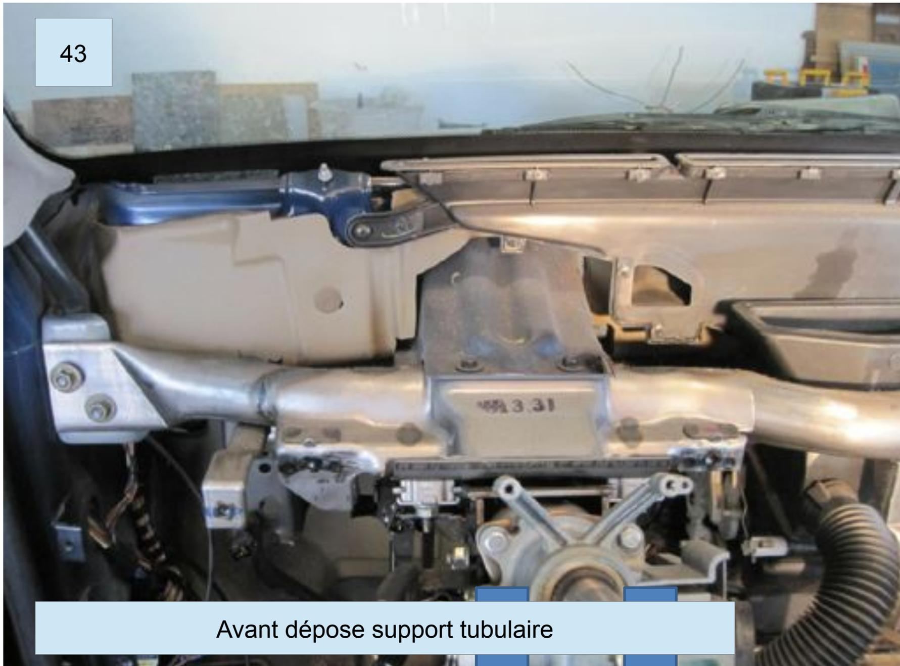
Avant dépose support tubulaire
