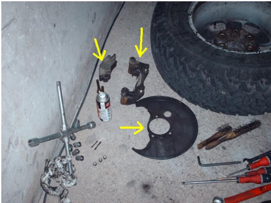
3- voici les plaquettes, l'étrier et le cache poussière.
