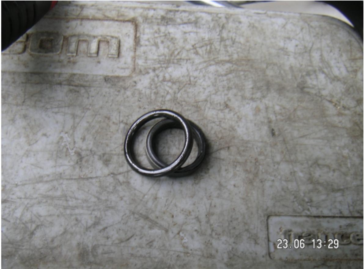
Joint torique et joint d'injecteur : Joint torique sur traverse et joint d'injecteur entre injecteur et traverse
