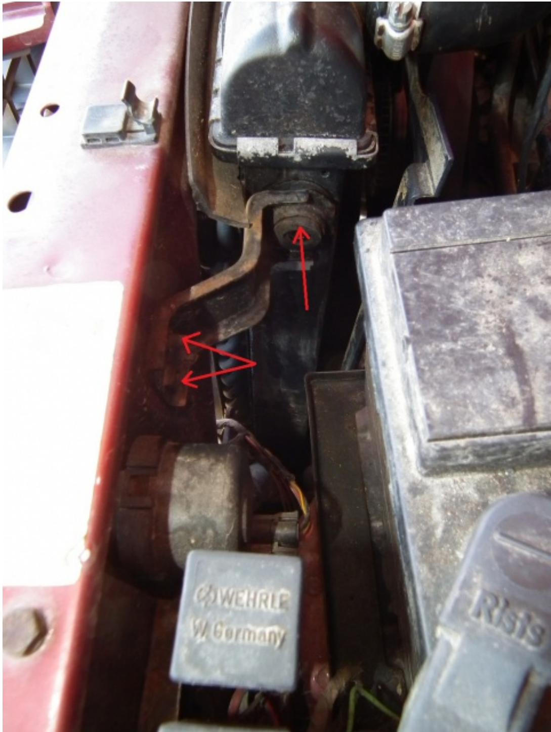
La patte, 2 vis, un téton et un silenbloc ! rien de plus simple !
