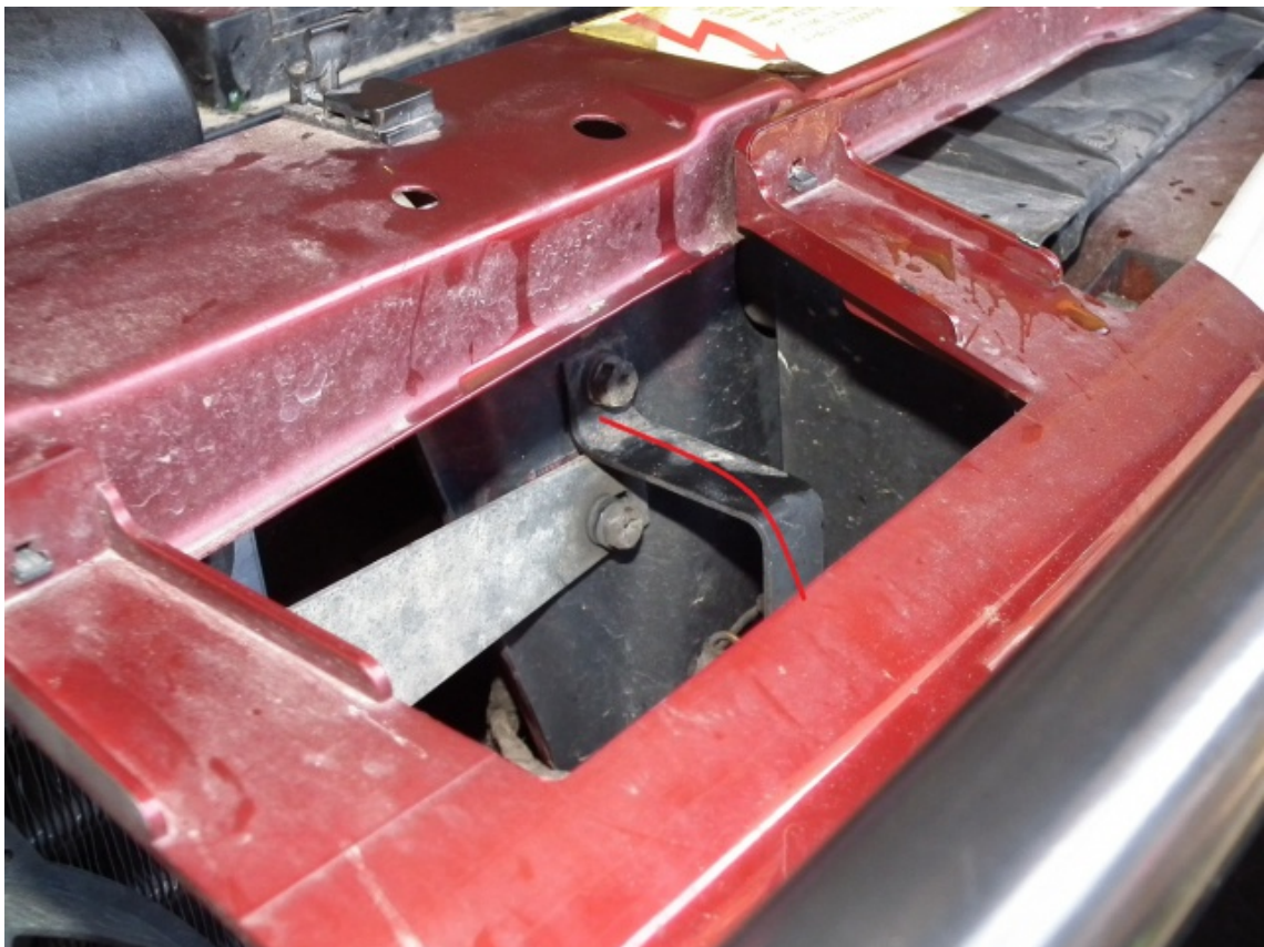
La patte qui soutient le klaxon ! A ne pas oublier au remontage !
