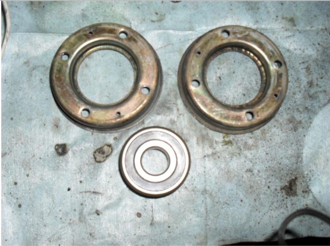
2- Remettre le roulement en place dans une demi-poulie
