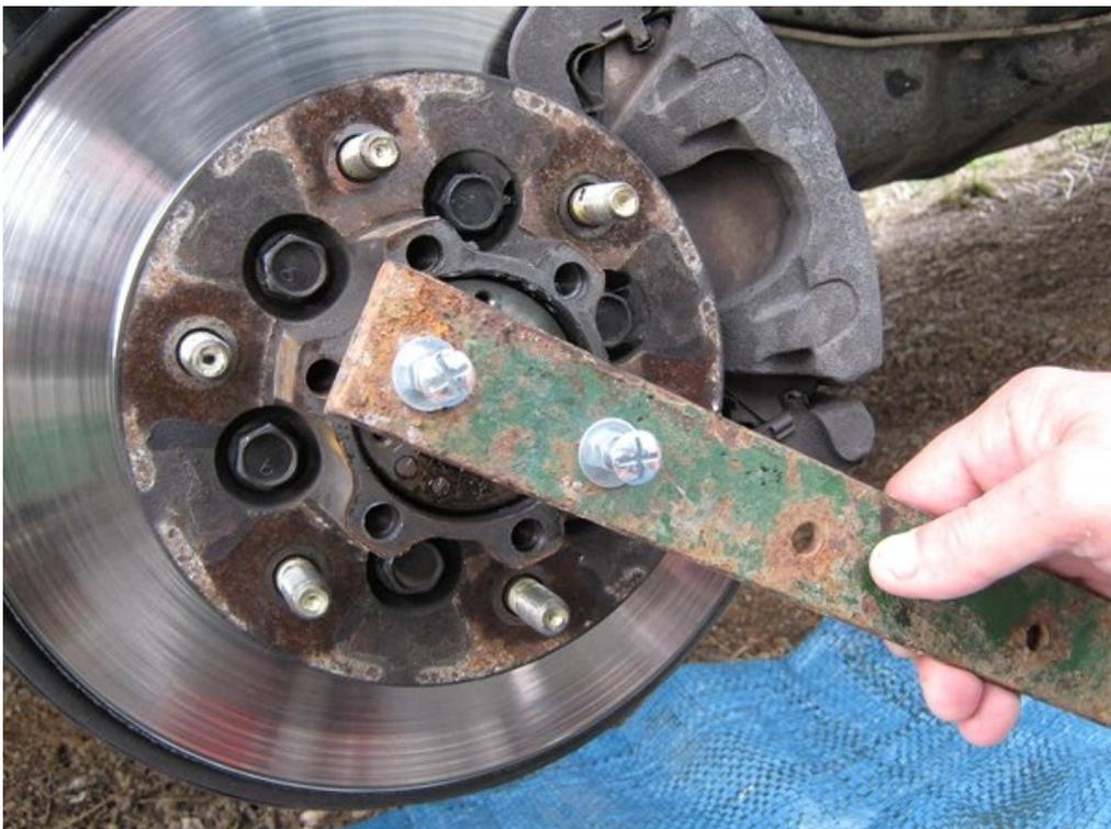
Et voilà le roulement est resserré : faire attention qu'en remettant la cale, les trous de vis tombent en face des perçages de cette cale.
