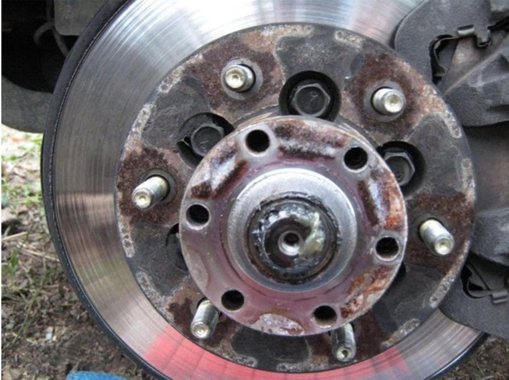
Dévisser les 3 petites vis à tête cruciforme et sortie la cale qui maintient le serrage du roulement
