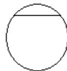
faire dans la partie haute du tube, une travée de 12mm de large sur 12 de profondeur
