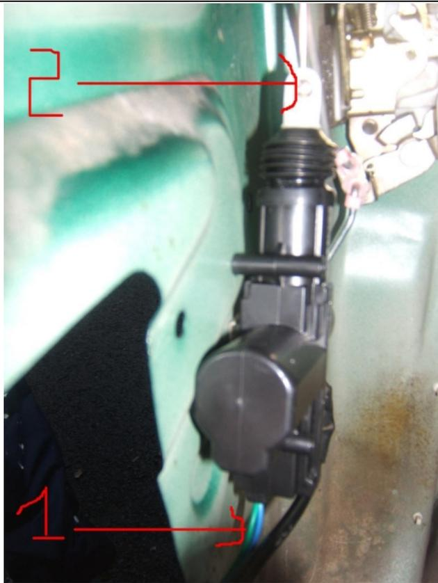
Raccorder la tringle d'origine avec la tringle fournie avec le moteur
