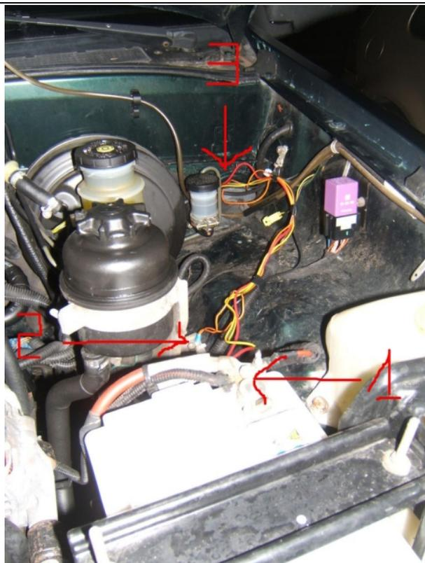
Passage des fils de l'habitacle au capot par le cache en caoutchouc numéro 1
