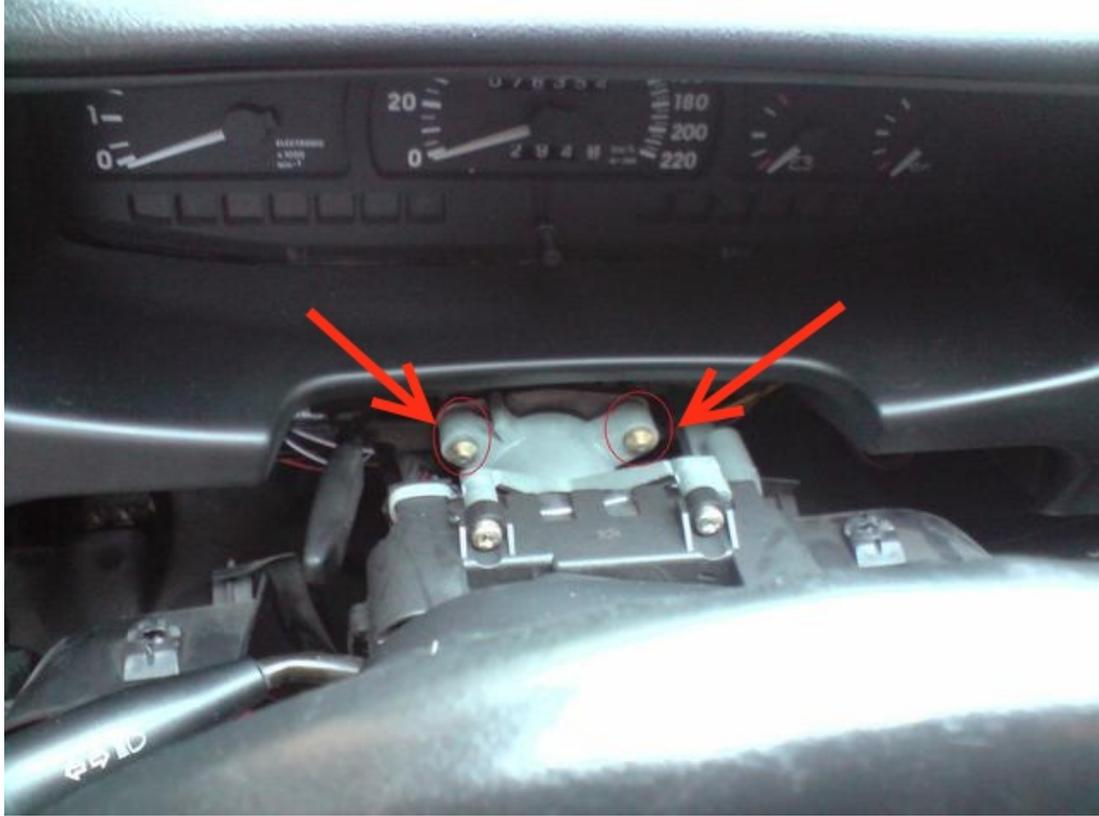
Flèches rouges : les vis à resserrer
