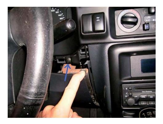
• Dégrafer doucement le bloc du haut et déconnecter les 03 fiches électriques (emplacement flèches bleues).
