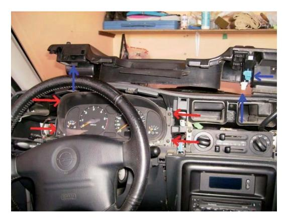
Une fois le bloc déposé, retirer les quatre vis du bloc compteur (flèches rouges).
